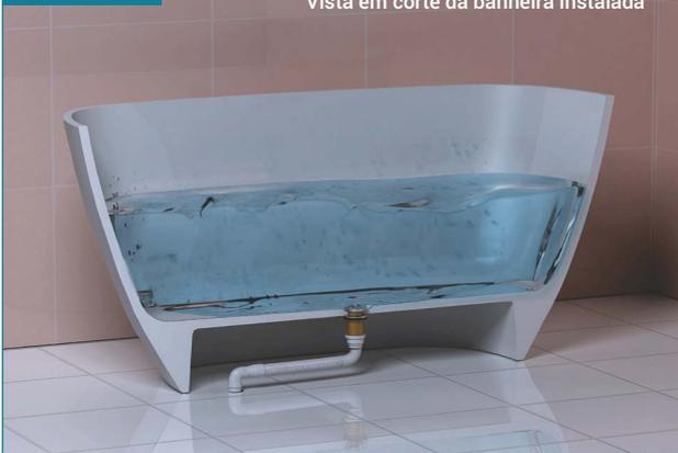
Retorne a banheira à posição original e encha de água para testar se ocorrem vazamentos.
