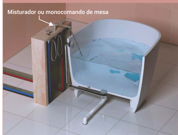
Opção 4: Monocomando de mesa instalado na mureta
